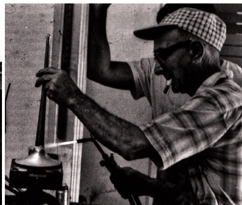
Bill Cardwell in seinem Labor und seinem „Salpingometer“. Cardwell ließ 2 dieser „Athena“ F Trompeten durch Domenick Callicchio bauen, (rechts) Herr Domenik Callicchio beim „Bell-brazing“ einer „Athena“.
